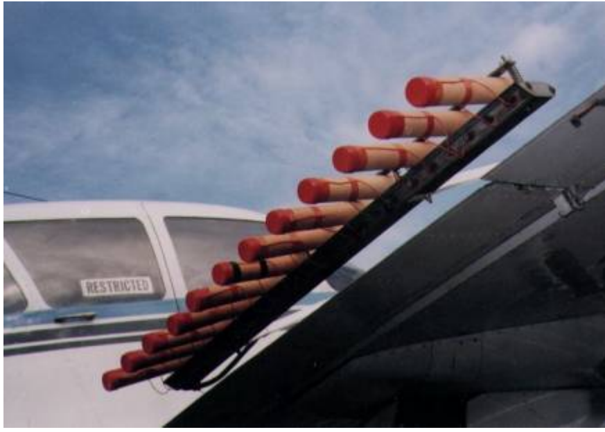
Uçak kanadına takılmış bulut tohumlama fişekleri
