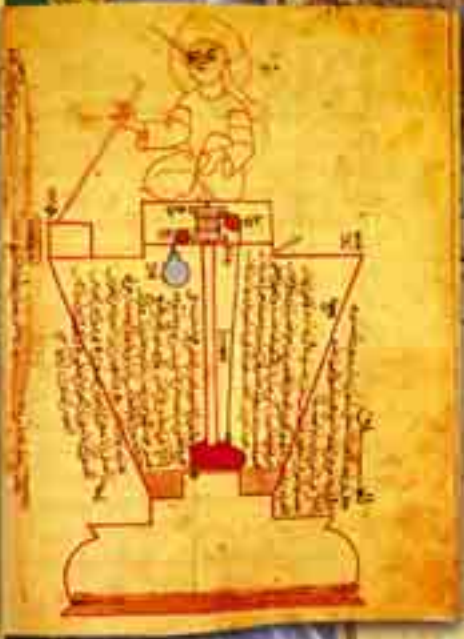
Apparatur von al-Haskafi zur Messung der Veränderung des Wasserspiegels
