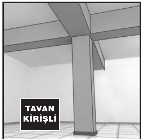
GÖRÜNTÜLERDEKİ EVİN TAVANI: BETONARME PLAK DÖŞEME (SARKAN KİRİŞLİ TAVAN)
